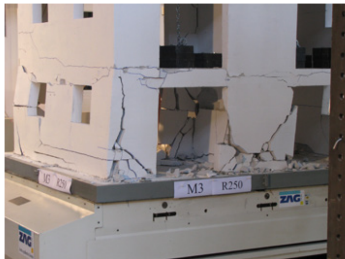
Slika 4. Tipične poškodbe zidovi v pritličju modela pri mejnem stanju porušitve
