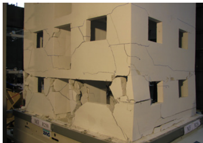
Slika 5. Navpična zidna vez ob robu zidu v pritličju modela pri končnem mejnem stanju
